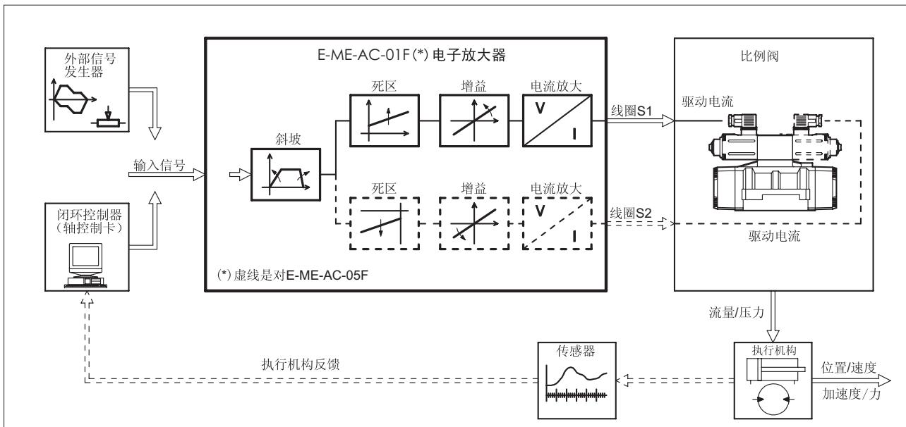
**E-ME-AC型电子放大器**用于驱动Atos不带压力或位置传感器型比例阀，根据输入参考信号大小对比例电磁阀提供对应的电流信号，以调节控制阀芯位置，流量和压力。
